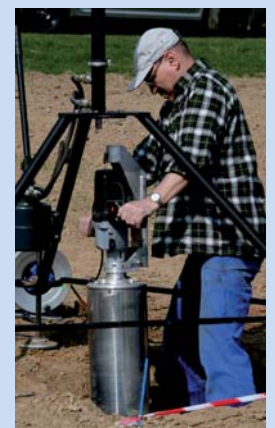
Entnahme von ungestörten Bodensäulen
